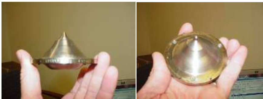
Figure 2.4: Filtre égalisateur pris d'un Varian 2100C, en mode 18MV
