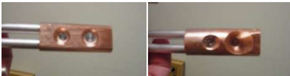
Figure 2.3: Cibles du Varian 2100C '6x/18x dual energy linac'. L'orifice droit est la cible du 18x et l'orifice gauche est celle du 6x. A droite : face de l'entrée du faisceau, à gauche face de sortie du faisceau
