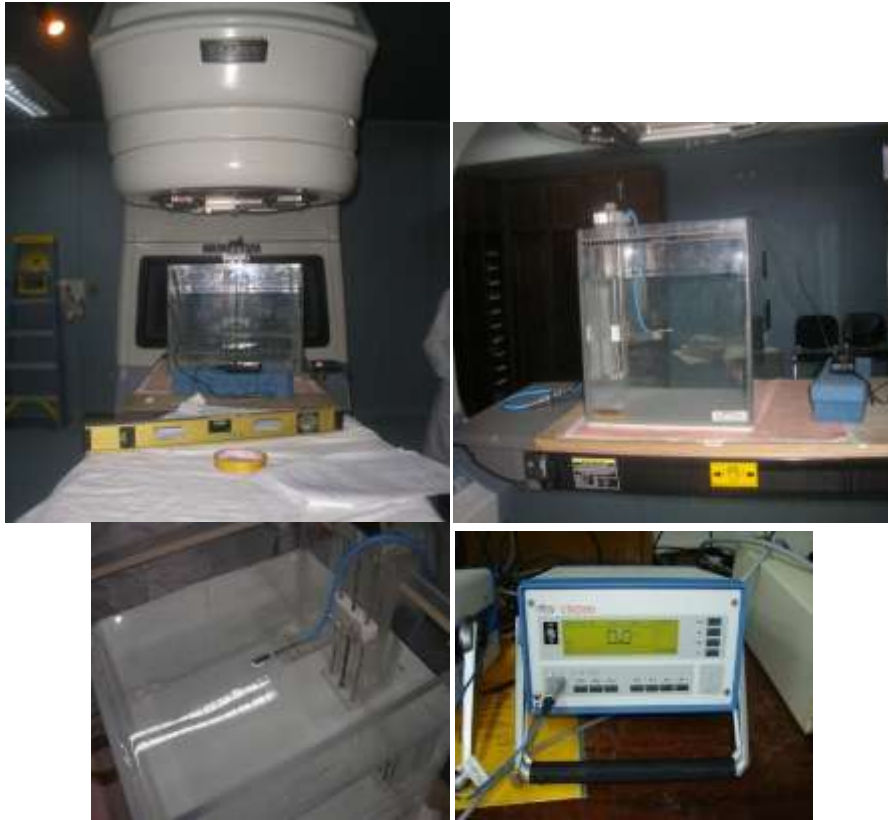
Figure 3.9 : Dispositif expérimental pour la mesure des distributions de doses : Varian 2100C, fantôme en PMMA, chambre d'ionisation et électromètre.
