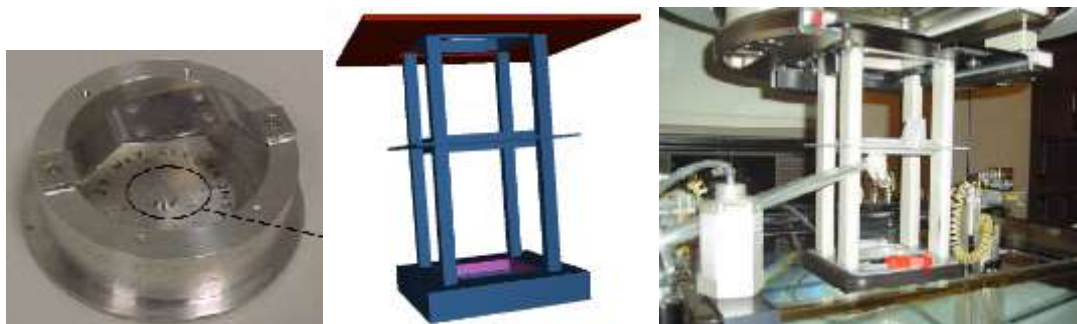
Figure 2.6: De gauche à droite : Feuilles de diffusion et Applicateurs pour les électrons du Varian 2100C pour le mode électrons
