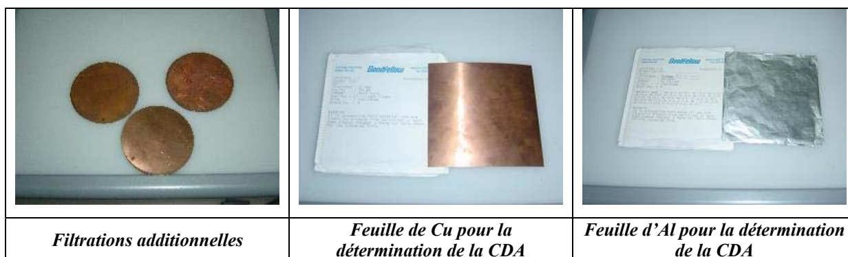
Figure 4.6 : Set up pour la détermination de la couche de demi atténuation CDA pour un faisceau RX et les différents filtres utilisés.
