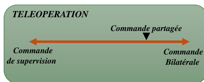
Figure 1.2 : Continuum de commande de la téléopération.
