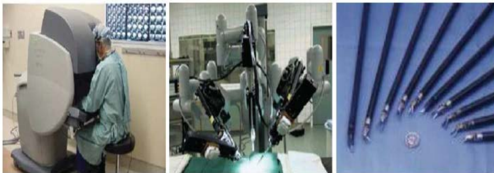
Figure 1.4 : Le robot téléopéré Da Vinci : (a) Station maître du robot, (b) station esclave avec deux bras porte-outils et un bras porte-endoscope (c) l'ensemble des instruments EndoWrist.
