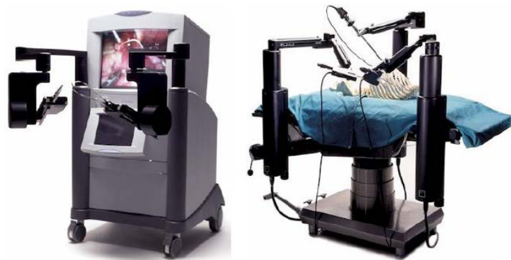
Figure 1.5 : Le système Zeus : à gauche la console de commande avec les bras maîtres, à droite, les manipulateurs esclaves.
