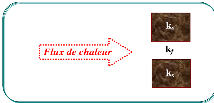
Figure II.11 : Modèle en parallèle de conductivité thermique effective k_e .
