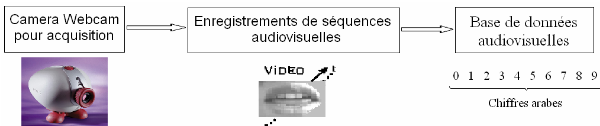
Figure 4.2 : Schéma synoptique du banc d'acquisition.
