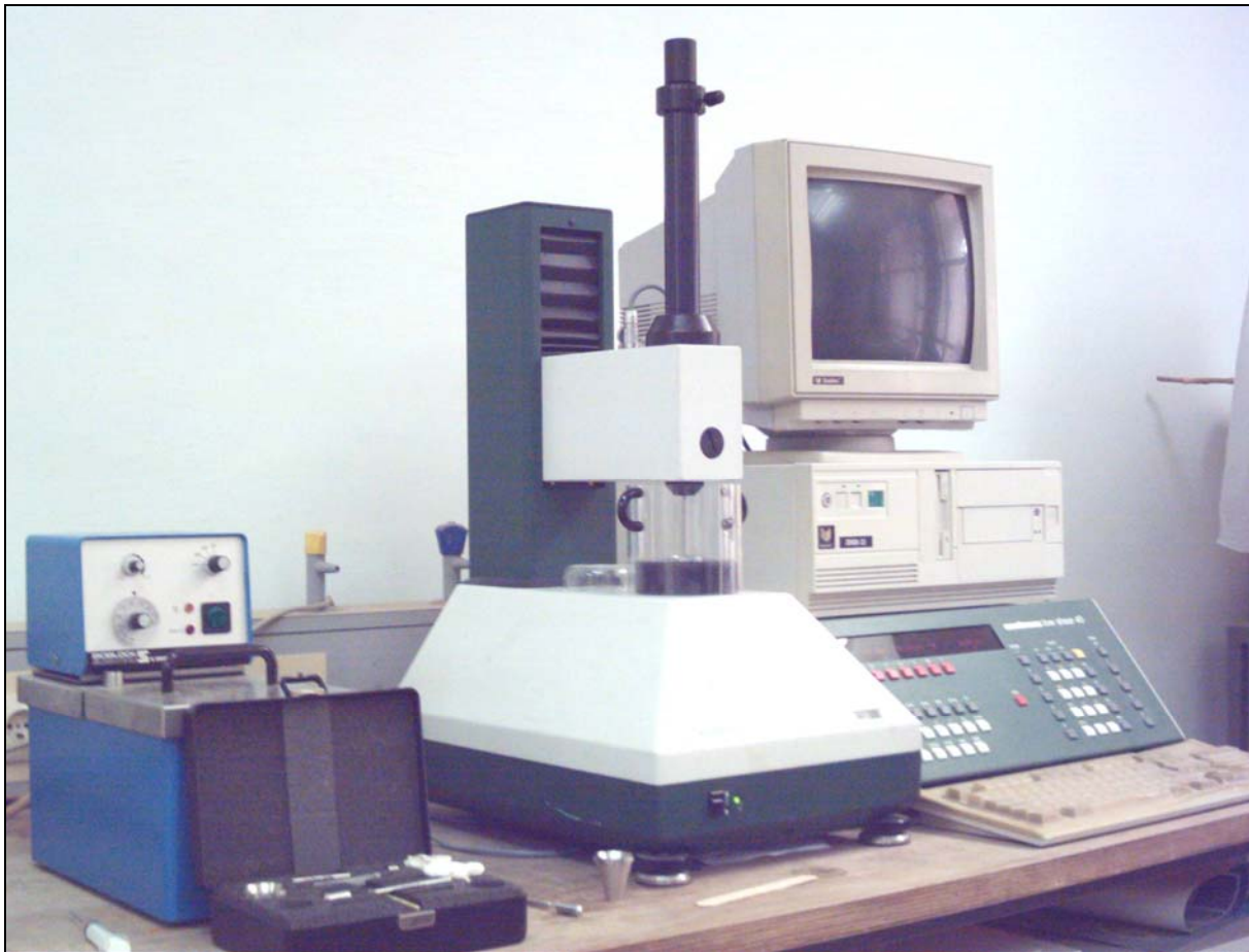
Figure III.7 : Viscosimètre Low Shear 40 de CONTRAVE.
