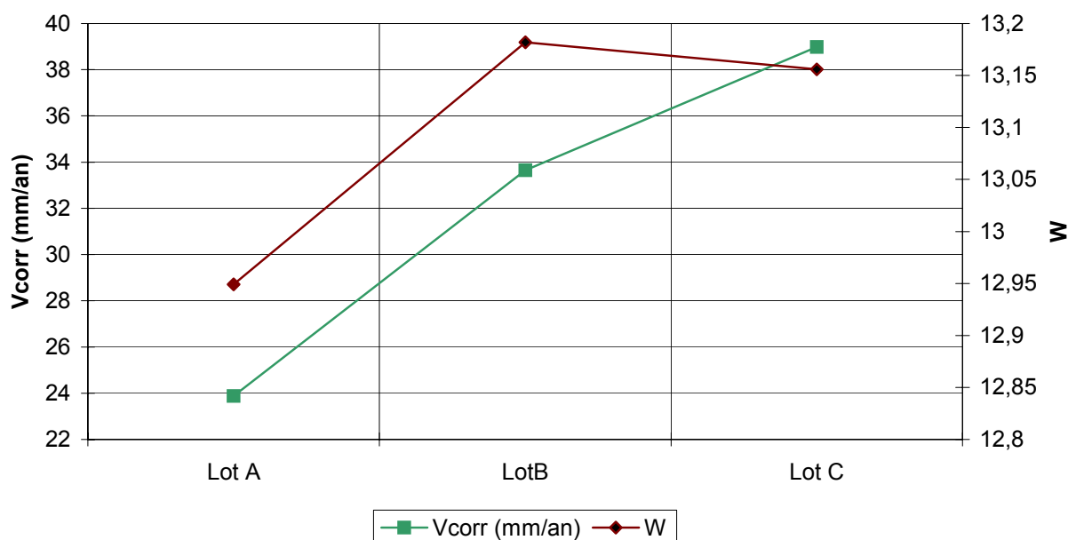
Figure 14. Effet du facteur W sur la variation de la vitesse de corrosion du tubing à 13%Cr ; ( W = \%Cr + 3.3 \times Mo\% )
