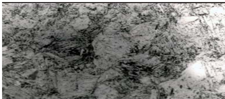
Figure 8. Microstructure du lot C constituée de martensite en aiguilles en transformation dans une matrice d'austénite résiduelle, 500X.
