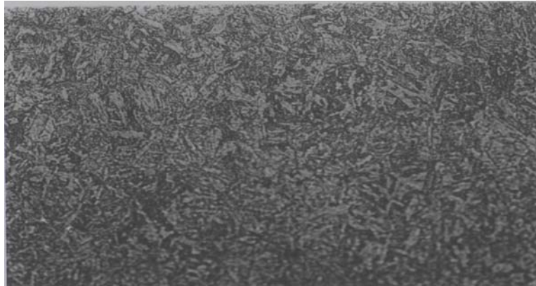
Figure 6. Microstructure du lot A du tubing à 13% Cr, constituée de martensite sous forme d'aiguilles fines et d'austénite résiduelle, 500X
