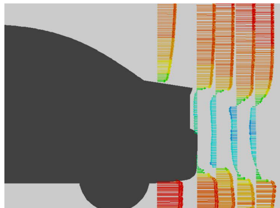
Figure V.21 : Champs de vitesse dans le sillage du véhicule dans les abscisses respectivement x/h=1.1, 1.32, 1.42, 1.52 et 1.62
