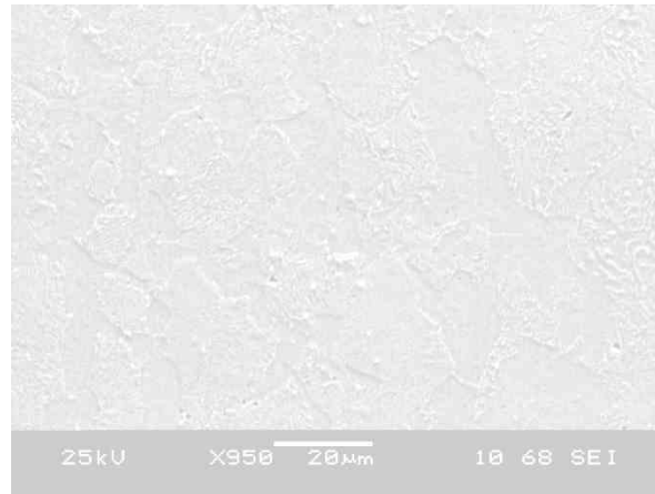
Fig. IV-1. Image MEB de la surface de l'acier XC 38 après attaque au Nital.
