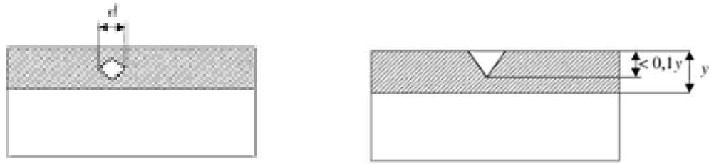
Fig. I-19. Test d'indentation des couches épaisses (a) et minces (b) [6].
