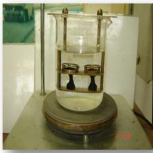
Figure 4.2. Appareillage et principe de l'essai de la température bille et anneau
