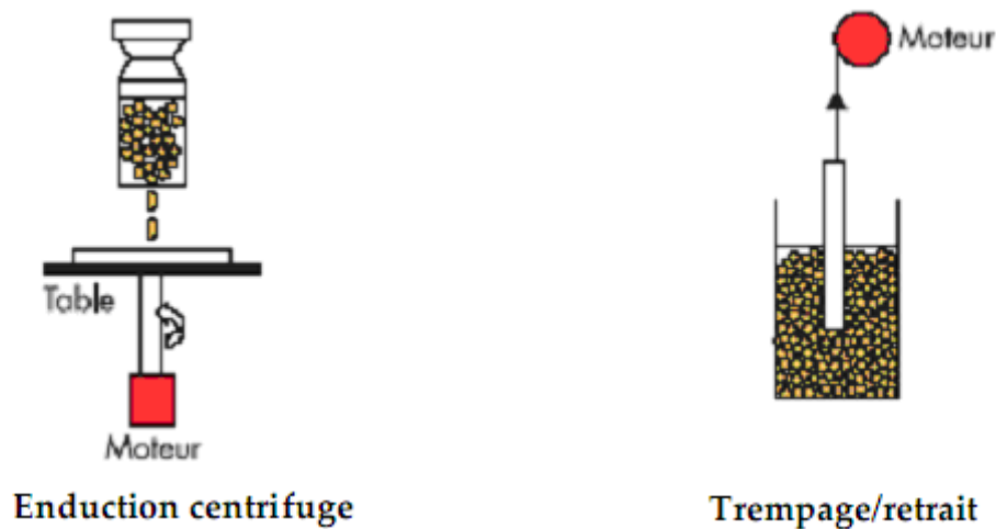
Figure (10) : schéma conventionnel de dépôt par sol-gel (dip-coating et spin-coating).
