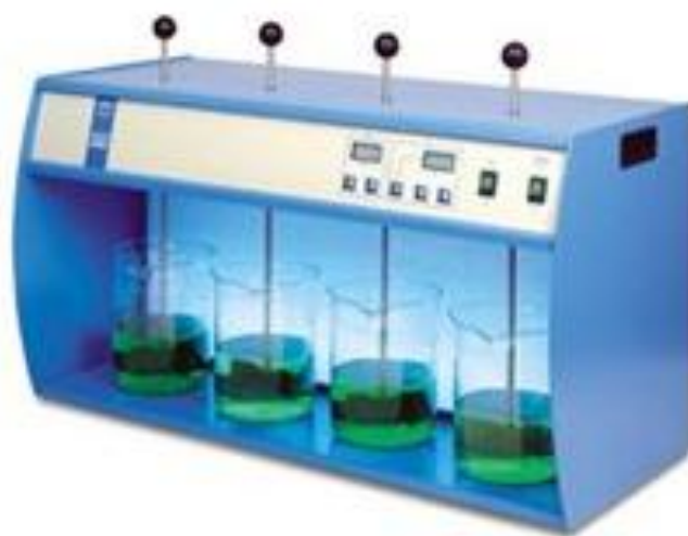
Figure III.3 : Dispositif expérimental de coagulation-floculation (Jar-test).
