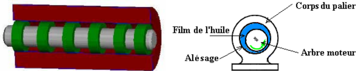
Fig. b : Tribologie des paliers de transmission des vitesses dans les machines Tournantes
