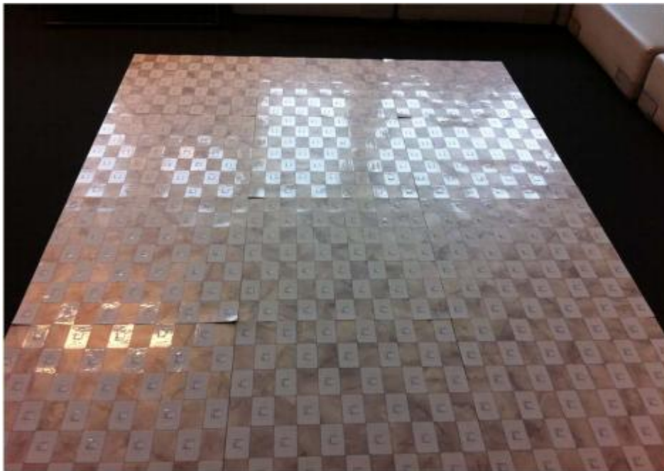
Fig.1-11 : la disposition des tags RFID sur le sol
