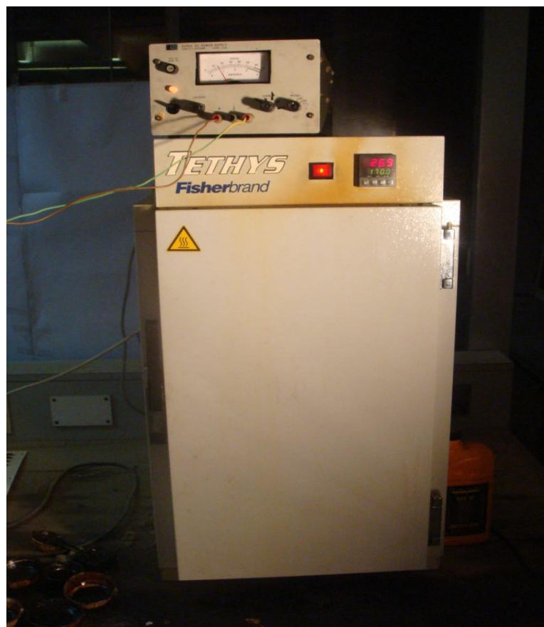
Figure III.4 : dispositif de revenu pour traitement de revenu.
