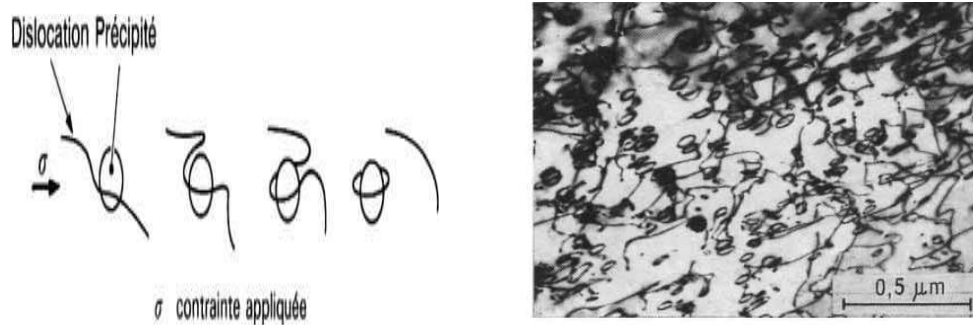
Figure I.9 :a) Représentation schématique du mécanisme de contournement d'Orowan.
