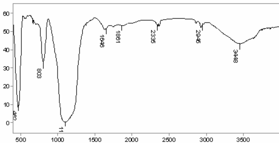
Figure II-9 : Spectre Infra Rouge du catalyseur 4%Ni-2%Mn /SiO 2 calciné à 500°C.
