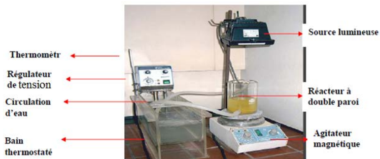
Figure 5: Dispositif expérimental utilisé pour l'évaluation de la photo-activité.
