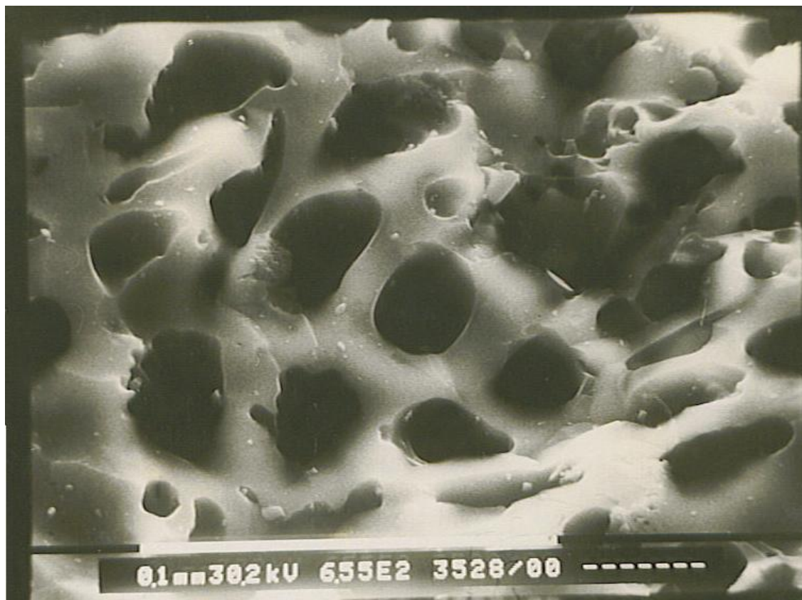
Figure IV-7. Photo SEM du charbon actif DK.
