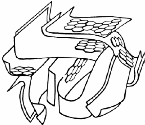
Figure I-2 : Représentation schématique de la microstructure d'un charbon actif d'après A.Oberlin[1]
