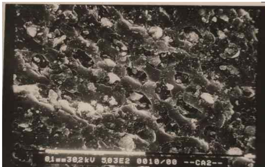
Figure IV-2. Photo de SEM de noyaux de dattes carbonisés à 600^{\circ}\text{C}
