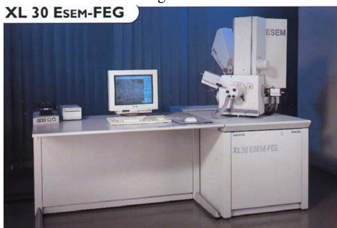
Figure 2.7 : Microscope électronique à balayage (FEG XL 30S)
