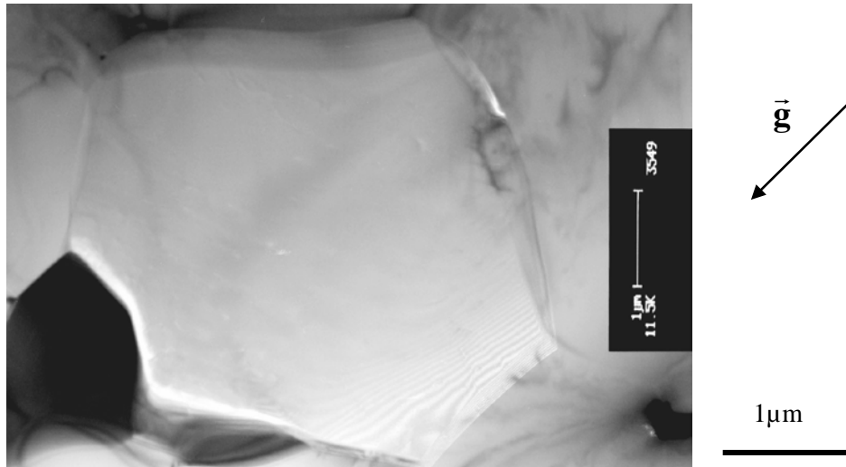
Figure 5.9 : Même grain que la figure 5.8, image obtenue en fond clair avec g = 1\bar{1}00 , les dislocations sont hors contraste
