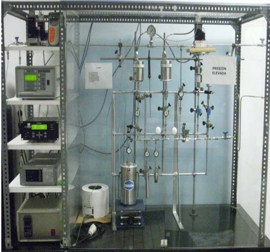
Figure 14: Appareil volumétrique utilisé pour l'adsorption de gaz à haute pression.
