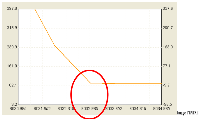
Figure 05. Détermination de l'heure exacte de la fin du rayonnement solaire sur une surface de la terre horizontale, détermination de la fin de charge.
