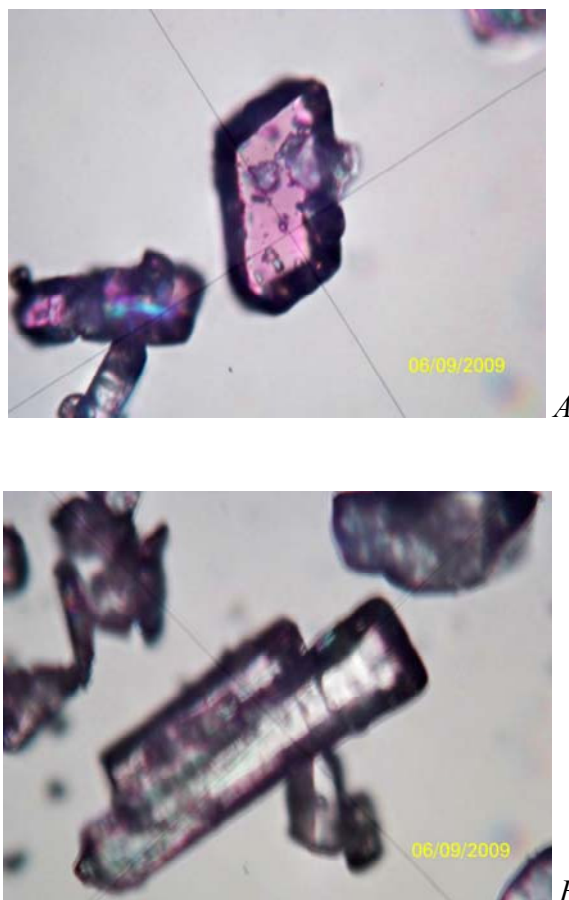
Figure II.4: Photographies réalisées au microscope optique des formes A et B du Triméthoprime.
