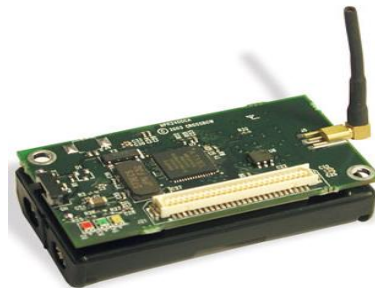
Figure 1.2. Exemple d'un capteur sans fil MICAZ de Crossbow.
