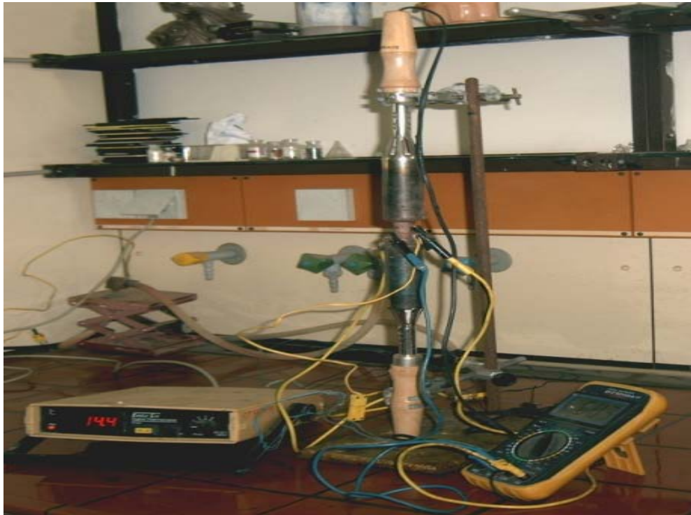
Figure VI-1. Dispositif expérimental utilisé pour les mesures de la conductivité électrique.
