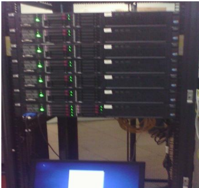
Figure III.9 : Photo du cluster avec 112 nœuds installé au niveau du laboratoire SNIRM.
