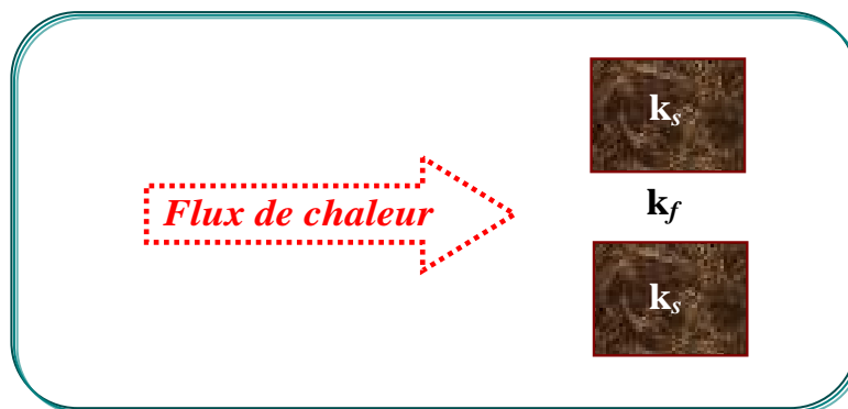
Figure I.7 : Modèle parallèle de la conductivité thermique effective k_e .
