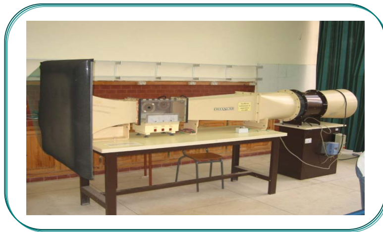
Figure III.1 : Soufflerie subsonique EA600
