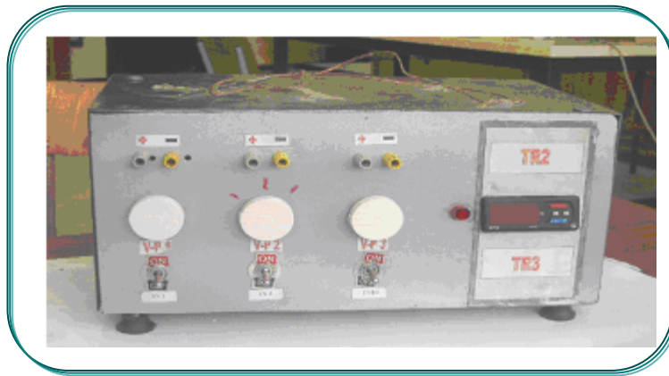
Figure III. 12 : Variateur de tension.
