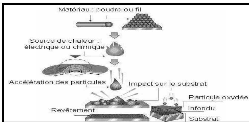
Figure I.2.2 : Principe de la projection thermique (d'après [7]).
