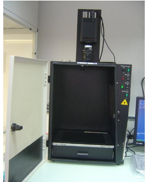
Figure 14 : Appareil photo caméra, qui sert à révéler les bandes après amplification
