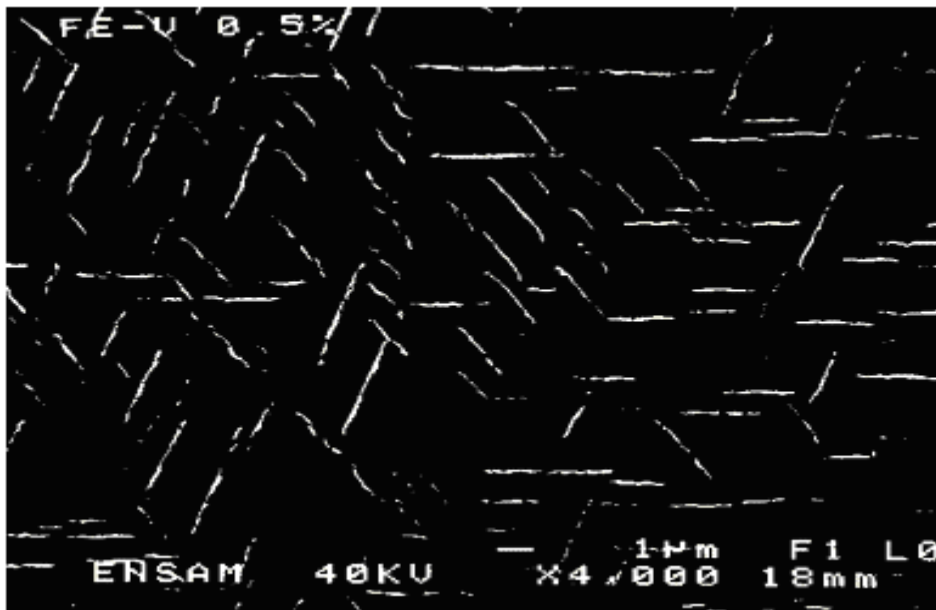
Figure 1.5 précipitation semi-cohérente dans la zone de diffusion lors de La nitruration d'un binaire Fe-0.5%V[23].
