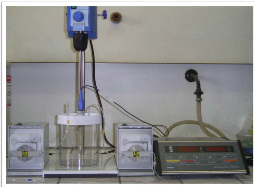
Figure 2 : Montage permettant la synthèse de HDL par co-précipitation à pH constant
