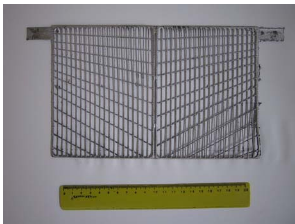
Figure II-2 : Une grille de batterie fournie par la société ENPEC.
