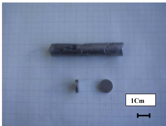
Figure III-1 : Photographie d'un lingotin d'alliage Pb-Sb et de deux échantillons découpés du lingotin.
