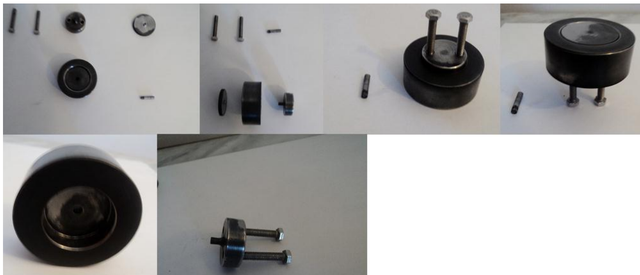
Figure IV.1 Image de la matrice de compactage
