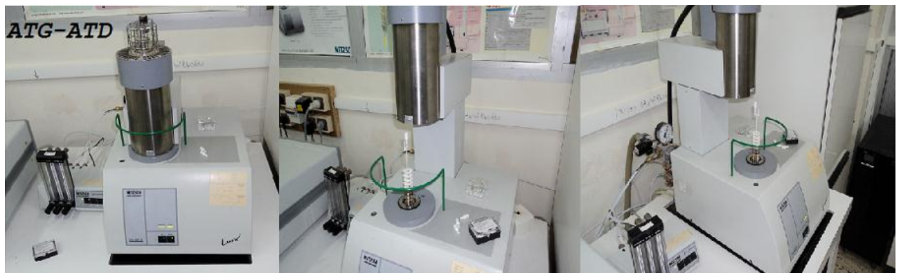
Figure IV.3 Appareil de mesure des vitesses d'oxydation 'ATG/ATD'.
