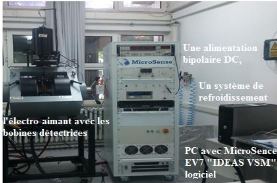
Figure II. 23. Magnétomètre à échantillon vibrant de système MicroSenceEV7 (Vibrating Sample Magnetometer) ;(ATTF), l'Université Anadolu. & Müh., Turquie: aperçu de la configuration.
