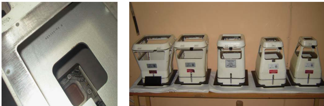
Figure 4.2 : Les applicateurs de l'accélérateur VARIAN 1800 et les différents étages de collimation dans ces applicateurs (scrapers).
