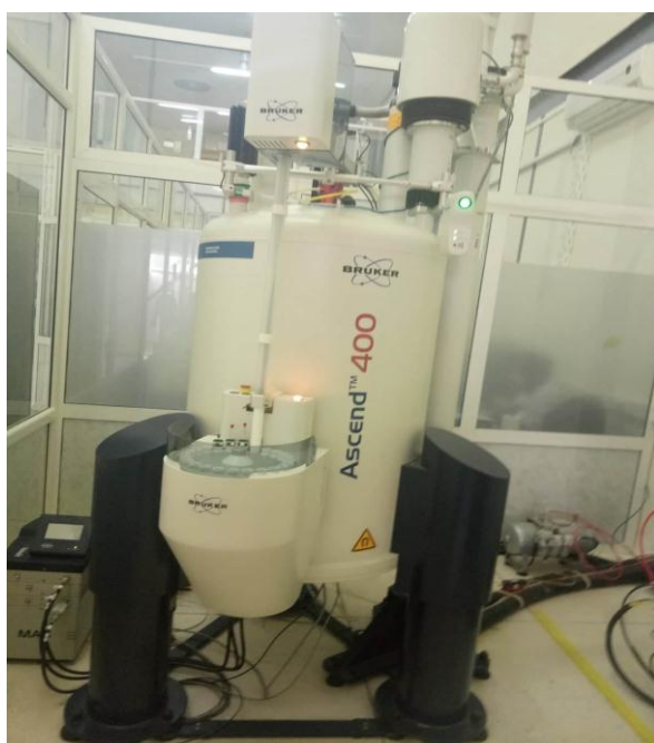
Figure 6 : L'appareillage de la Résonance Magnétique Nucléaire (RMN) utilisée (Laboratoire du CRAPC).
