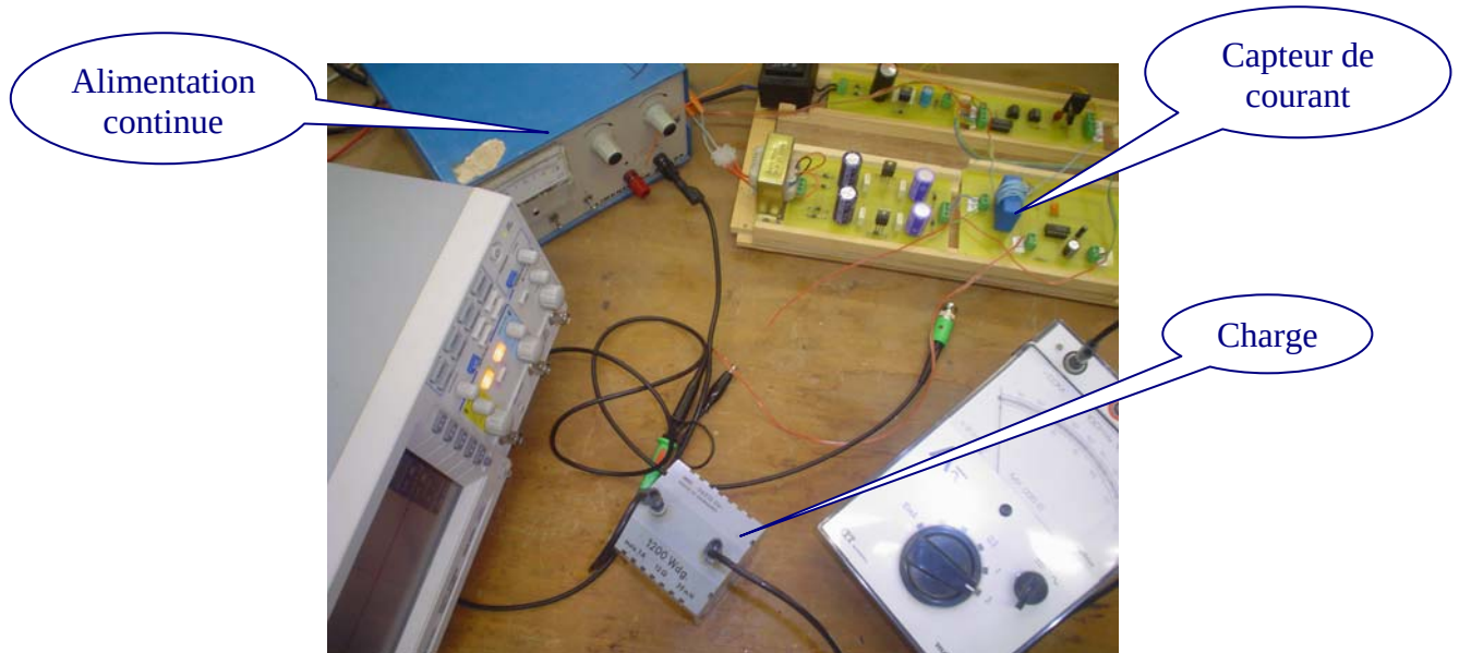
Figure II.14 Montage utilisé pour étalonner le circuit de mesure
