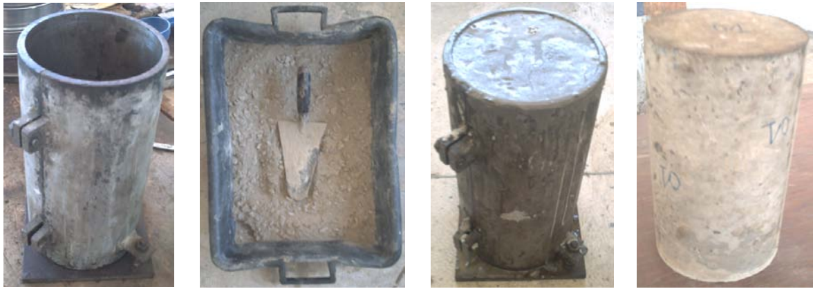
Fig II.9 : Les étapes de préparations des éprouvettes d'essais de compression.
