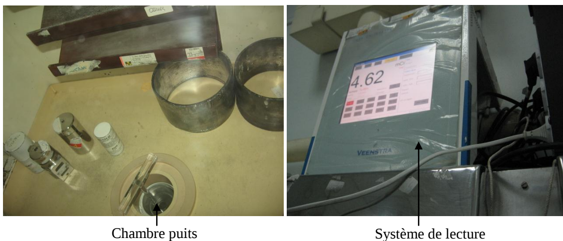
Figure III.3 : Activimètre (chambre puits à gauche, système de lecture à droite)
