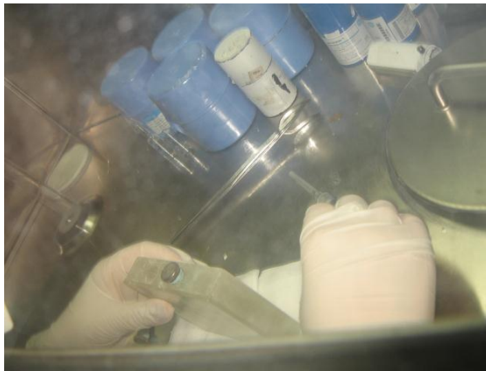
Figure III.17 : Remplissage du fantôme de thyroïde
