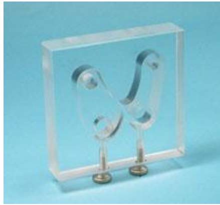
Figure III.7 : Le fantôme de thyroïde (Biodex 128 – 340)
