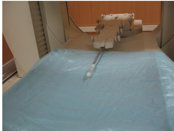
Figure III.13 : Dispositif expérimental utilisé pour la mesure de la résolution et de la sensibilité
