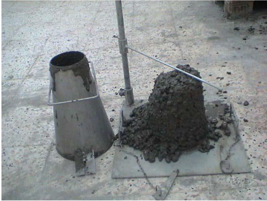
Figure3.8: Essai d'affaissement (cône d'Abrams)
