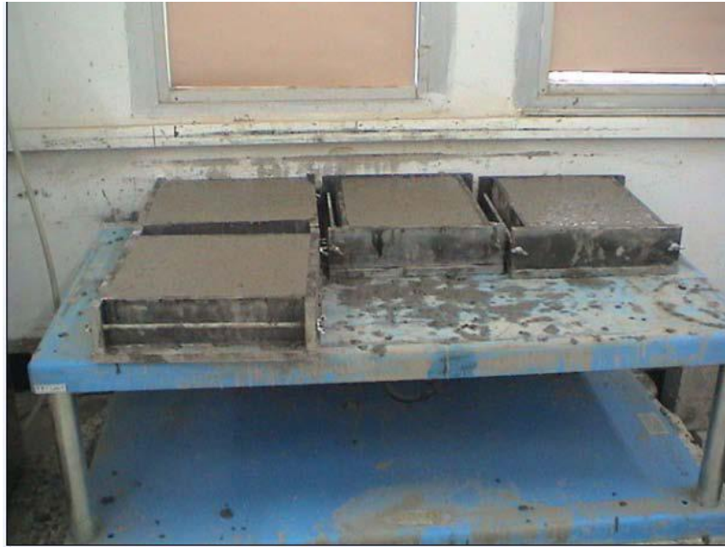
Figure 3.7 : Compactage du béton à l'aide d'une table vibrante
