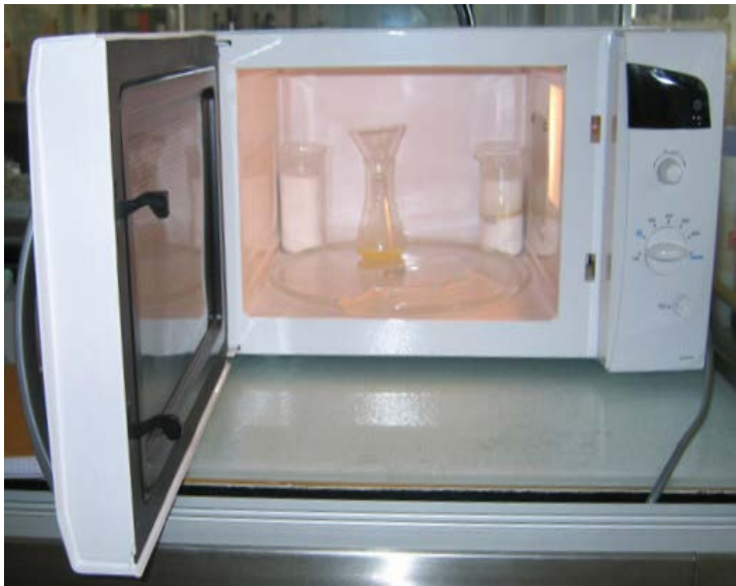
Figure 4 : Four a micro-onde domestique modifié
