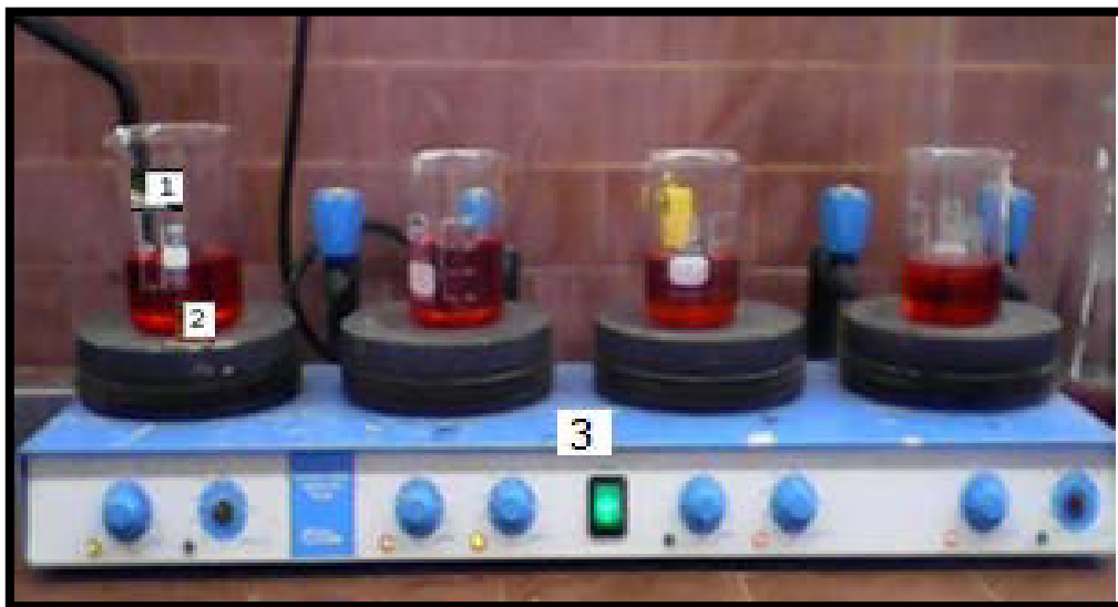
Figure V-5 : Dispositif de la dépollution des eaux par biosorption.
