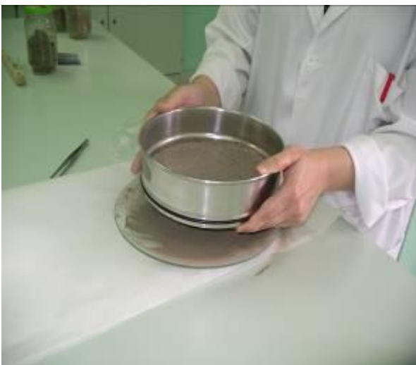
Photo N°23: Tamisage du prélèvement puis extraction de UN par acétone chaude à partir des débris métalliques et de la terre pour subir à la fin la filtration
