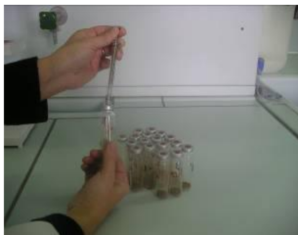
Photo N°19: Les tubes head-space contenant l'échantillon de terre sont mis dans l'étuve puis la phase vapeur est prélevée par une seringue à gaz et injectée dans le GC/MS
