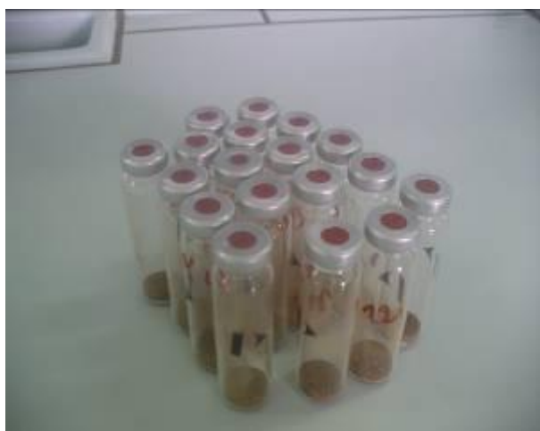
Photo N°19: Les tubes head-space contenant l'échantillon de terre sont mis dans l'étuve puis la phase vapeur est prélevée par une seringue à gaz et injectée dans le GC/MS
