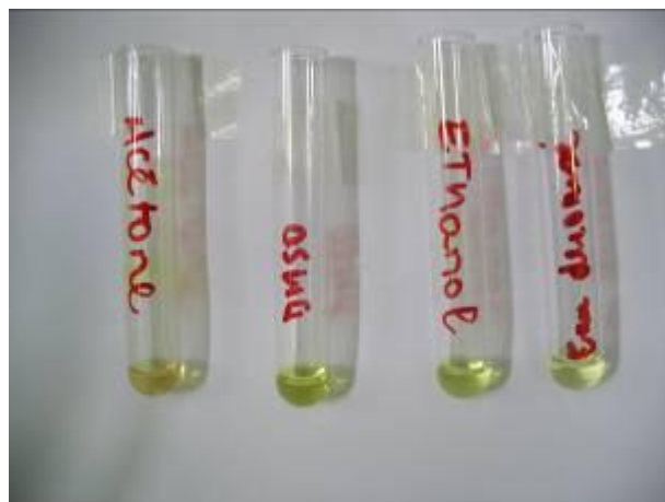
Photo N°20 : Le test de dissolution et la présence de UN révélée par le réactif chimique PDMAB (Couleur jaune test positif)
