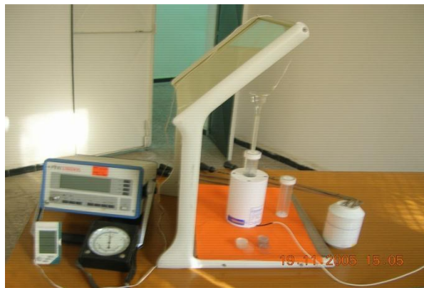
Figure 4.9 : Chambre d'ionisation Puits et son électronique associée
