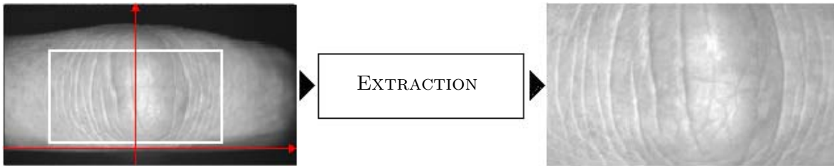
FIGURE A.19: Extraction de la ROI à partir l'image de doigt.
