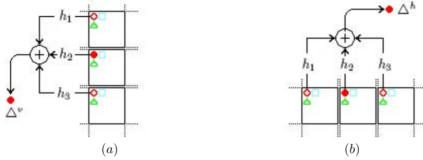
FIGURE 5.6: Calcul des coefficients deltas correspondant à une fenêtre 1D. (a) Coefficient deltas vertical et (b) Coefficient deltas horizontal.
