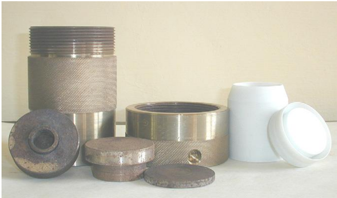
Figure II.1 : Présentation d'un autoclave à usage général : traitement et synthèse hydrothermale.
