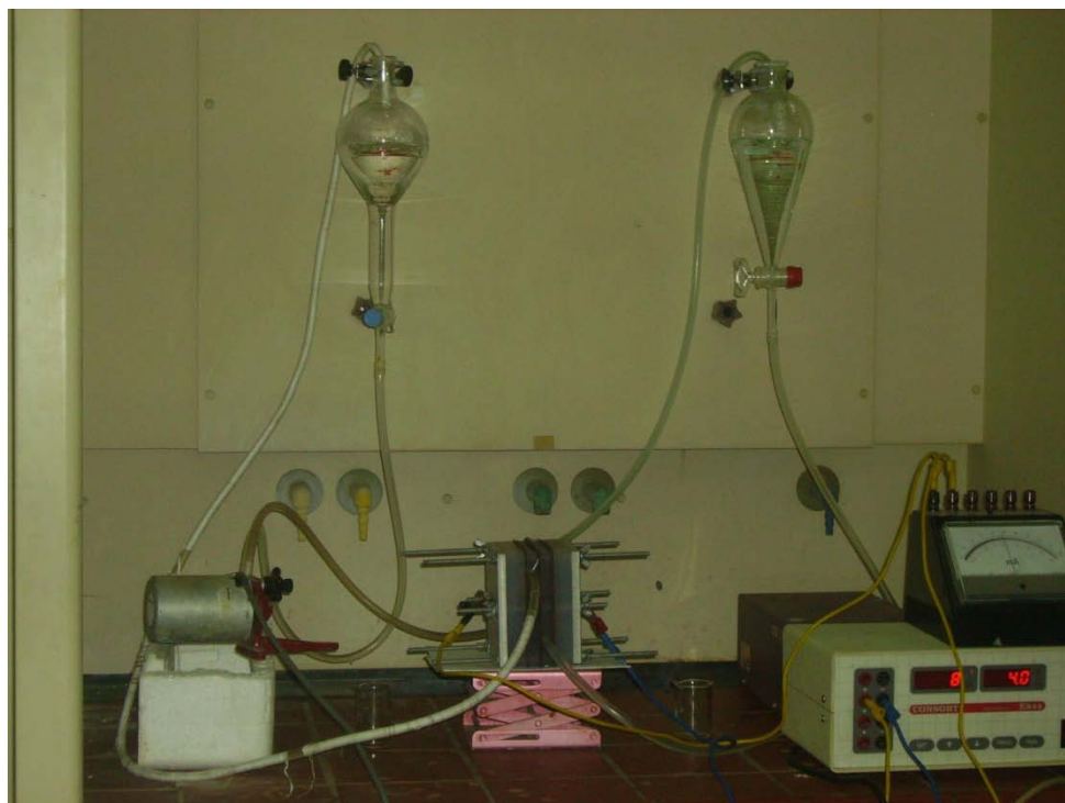
Fig III.8 : photo globale du dispositif expérimental de l'électrodialyse utilisé au laboratoire
