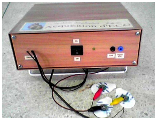
Fig.2.17. Système de recueil du signal ECG réalisé
