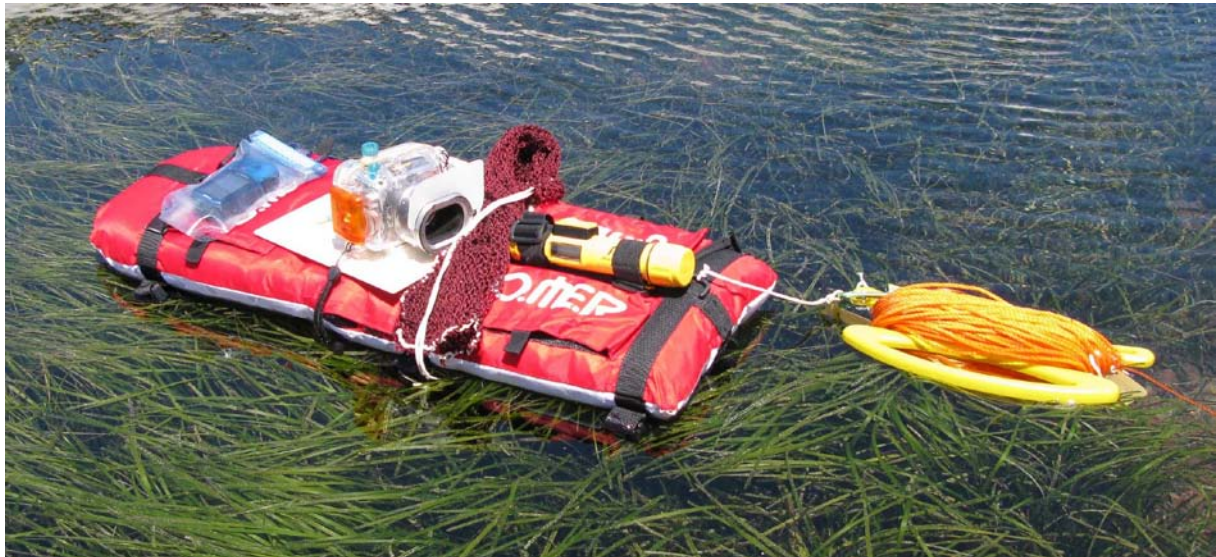
Figure : 16 : Matériel vérité terrain en Apnée (planche d'apnée sur la quel accrochés de gauche à droite GPS, Ardoise, Appareil photo, filet, Sondeur à main, et enrouleur de corde)
