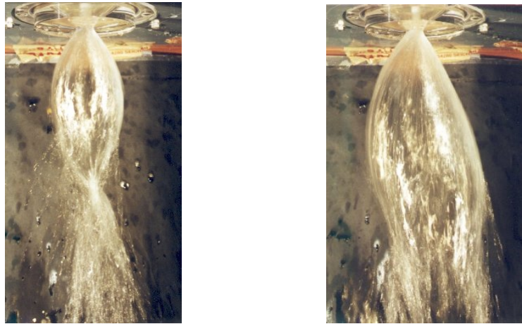
Figure I.4 : Visualisation expérimentale de jets en rotation
