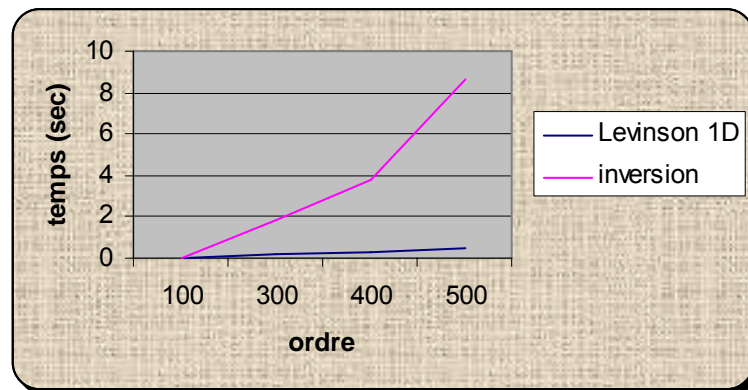
Fig. II.10. Temps de calcul des paramètres AR 1D en fonction de l'ordre
